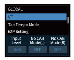
No CABモードは、保存されたプリセットを変更せずに楽器用アンプへ接続したい時に使います。
