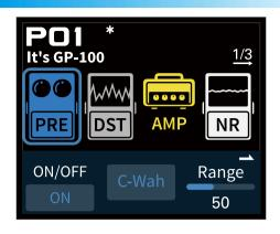
PARAノブを回す、またはフットスイッチをタップしてパッチを変更します。PARAボタンまたはEDITボタンを押すと、EDITメニューが表示されます。このメニューは、本機中の9つのエフェクトモジュールを表す10個の四角いアイコンで構成されています。
