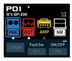
ストンプモード内でのトーン編集はパッチモードとほぼ同様です。フットスイッチでのコントロールモジュールの選択機能が増えます。: このモードでは、[+]/[-]フットスイッチでコントロールされるモジュールを示すため、モジュールの下に「▲」と「△」の二つのマークが表示されます。FS1は[-]フットスイッチで、コントロールされているモジュールを示します。FS2は[+]フットスイッチで、コントロールされているモジュールを示します。OFFを選択するとコントロールが解除されます。
