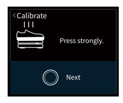
ペダルをトウ側に強く踏み、PARAボタンを 押してNextを選択します。
