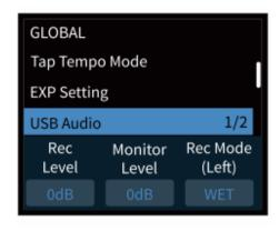
このメニューは本機をUSBオーディオインターフェイスとして使用する際、USBオーディオ設定に使用します。Rec Mode項目では、USBで録音した左(L)と右(R)インプットチャンネルのソースを選択できます。両チャンネルともドライシグナル(Dry)とエフェクトシグナル(Effect)が選択できます。録音する際、使用している楽器や音源に適した録音レベルを調整しましょう。
