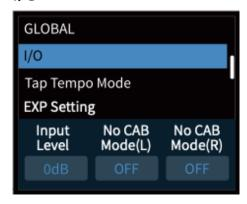
I/Oメニューで本機全体のインプットおよびアウトプットのレベルを設定します。
